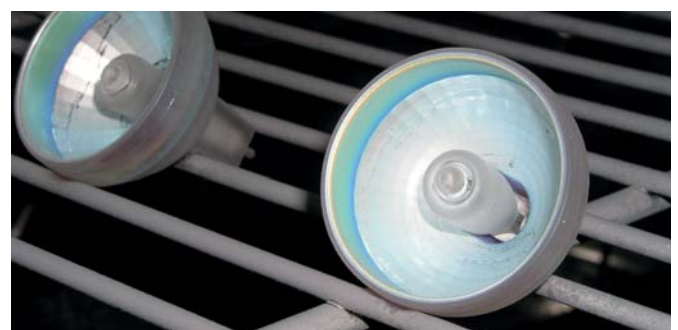
Kälteprüfung an verchromten Strahlern
