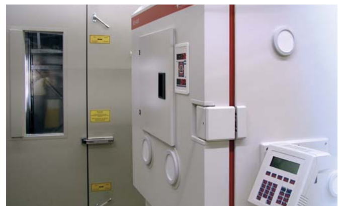
Klimakammer (-40°C bis +180°C, mit Feuchteregelung) Kälte-Wärmekammer (-30°C bis +90°C)
