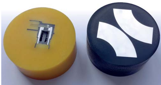
Schliffpräparation: Längsschliff (links) und Querschliff (rechts)
