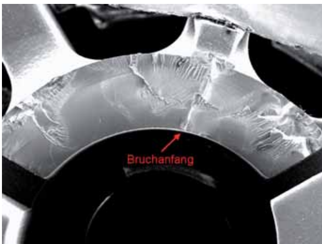
Spannungsriss (Sprödbbruch) in einem ABS-Kunststoffteil (15 : 1)
