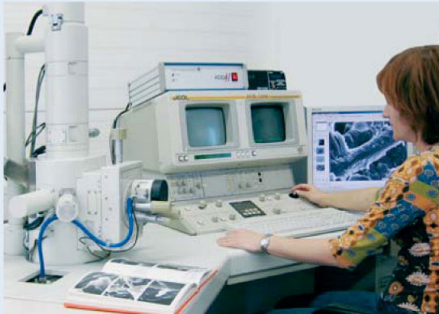
Das absolute Highlight des neuen Equipments bildet ein Rasterelektronenmikroskop mit EDX-Analyse, das noch „tiefere Einblicke“ in die Strukturen der Werkstoffe ermöglicht.
