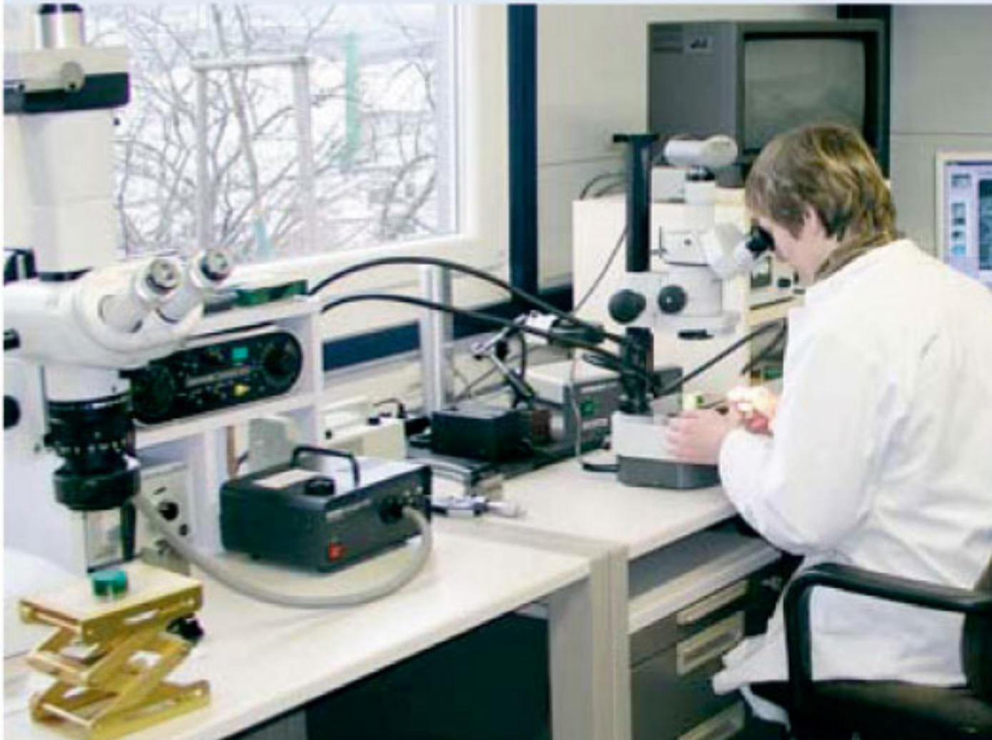
Nach erfolgter Probenpräparation wird das Gefüge unter dem Mikroskop betrachtet.
